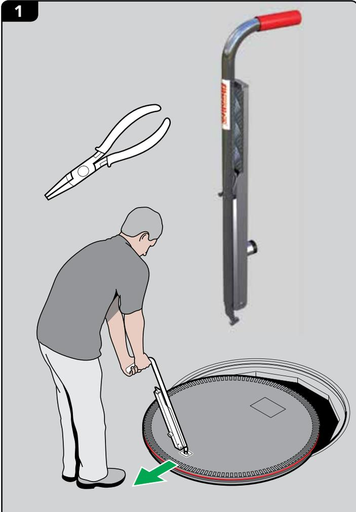
Para cambiar la junta va a necesitar un bastón con pedal FL7A y unos alicates. Lo primero que debe hacer es quitar la tapa del marco con el bastón FL7A.
