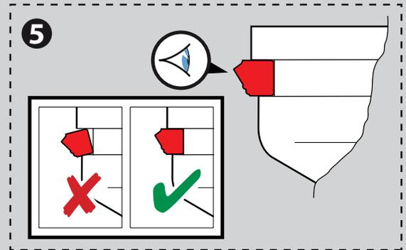
Tendrá que estirar el resto de la junta para colocarla en la ranura de la tapa. Después compruebe visualmente que la junta esté bien colocada.
