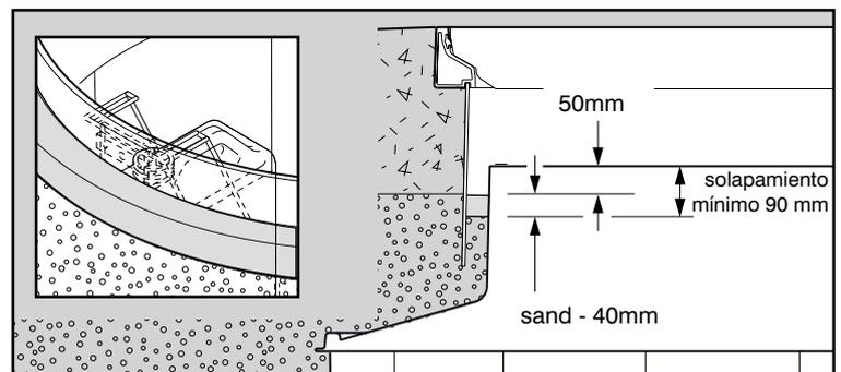
**51** El drenaje y la botella deben colocarse alejados de las tuberías y bombas sumergidas. El drenaje se debe instalar en el punto de más bajo nivel creado a propósito, compactando la arena en el punto elegido hasta llegar a 10-15 mm por debajo de la arena circundante.
