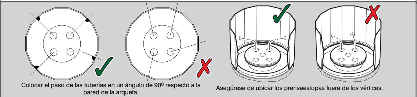
**17** Antes de la instalación de los prensaestopas, coloque una cuerda de marcaje de nivel para comprobar si va a necesitar cortar la arqueta. Si así fuera marque en la arqueta la línea de corte. Asegúrese de que tiene la distancia suficiente desde esta marca o desde el borde de la arqueta hasta el centro del prensaestopa que más alto vaya a instalar.
