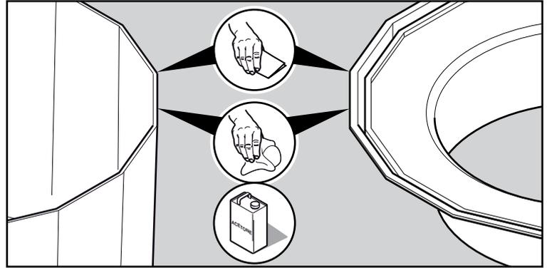
**33** Pruebe para comprobar que la ranura se ajusta al borde superior de la arqueta. Si no fuera así puede que la instalación de tuberías esté deformando la pared de la arqueta.
