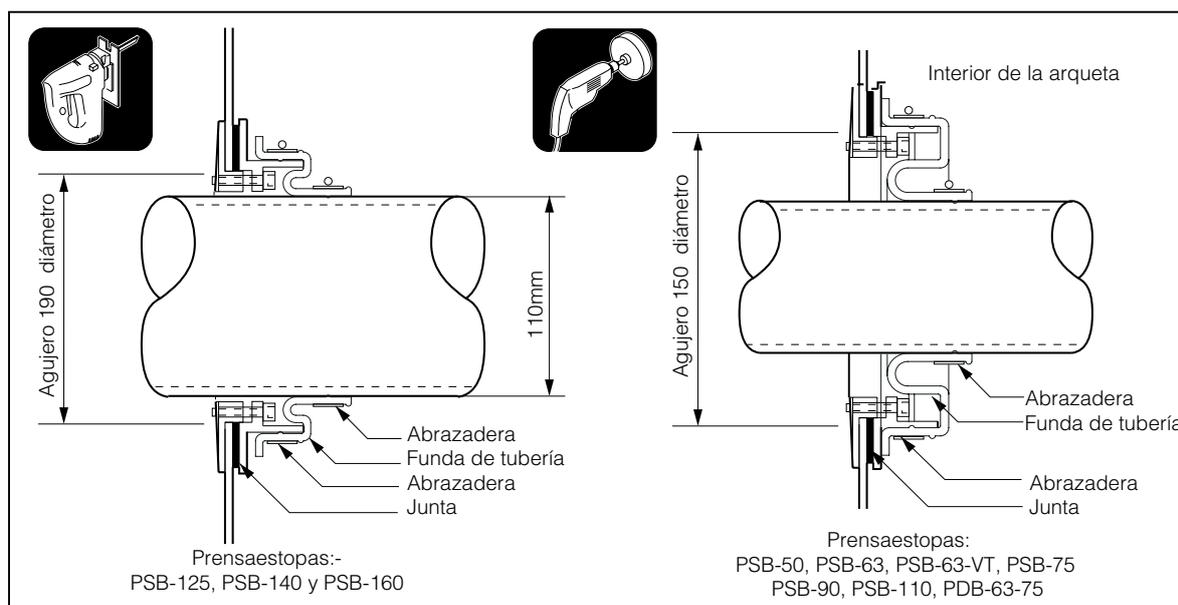
**Tenga Muy Presente:** Se recomienda el uso de una sierra circular de corte con broca central para hacer los agujeros de los prensaestopas en la arqueta. La posición de salida de la tubería por la pared de la arqueta debe ser lo más cercana posible a los 90°. El prensaestopa deberá instalarse de modo que la tubería quede centrada con la junta. Al rellenar asegúrese de que la tubería no se ha movido de su posición centrada.
