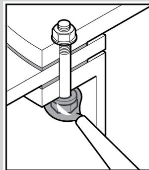
Como seguridad añadida se puede encapsular la cabeza del tornillo y la arandela Dubo con la masilla Soudaflex.
