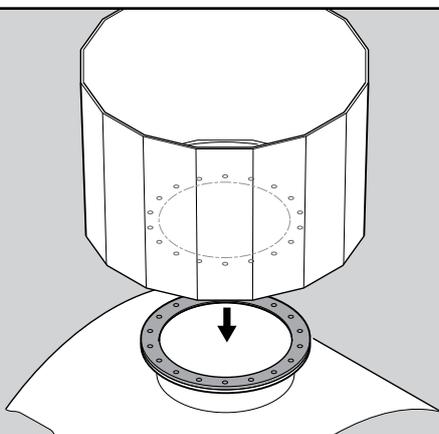
Coloque la arqueta sobre la junta previamente instalada en la brida del cuello, asegurándose de que los agujeros quedan alineados unos con otros y que la arqueta queda posicionada correctamente respecto a las líneas de las tuberías.
