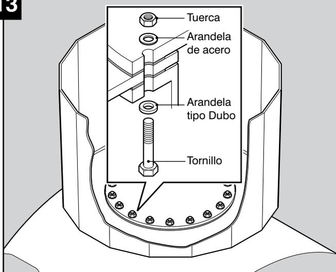
Coloque la tornillería como indicamos a continuación: La cabeza del tornillo en la parte inferior de la brida de la boca de hombre con una arandela de retención tipo Dubo entre la cabeza y la brida (No utilice ninguna otra arandela porque si no la arandela tipo Dubo no funcionará). En la parte superior hay que usar una arandela normal de acero y la tuerca.
