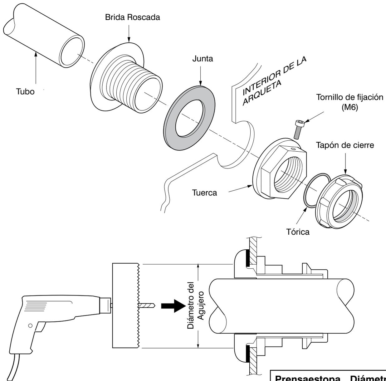
**Tenga Muy Presente:** Use el tamaño apropiado de sierra circular con broca apropiada para cada prensaestopa. El prensaestopa debe colocarse perpendicular a la pared de la arqueta y el tubo eléctrico debe entrar en éste perfectamente alineado. A la hora de rellenar asegúrese de que el tubo no se haya movido.
