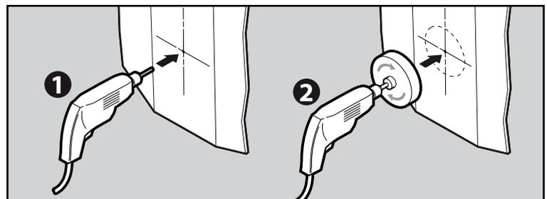
**19** Para agujeros muy grandes (190 mm) recomendamos marcar el agujero y utilizar la sierra caladora. Primero haga un taladro en la pared para insertar la hoja de la sierra y poder cortar con facilidad y seguridad. (El material de la arqueta desafilará las cuchillas normales rápidamente por lo que recomendamos usar cuchillas de diamante o cerámica).
