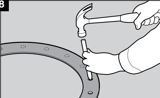
Si fuera necesario recorte la parte exterior y/o interior de la junta con una cuchilla para reproducir el diámetro exterior de la tapa de la boca de hombre y el interior de la brida del cuello de la boca de hombre. Usando la tapa de la boca de hombre como plantilla marque el patrón de los taladros sobre la junta. Utilice el saca bocados de 18 mm que se suministra y haga los agujeros con ayuda de un martillo.
