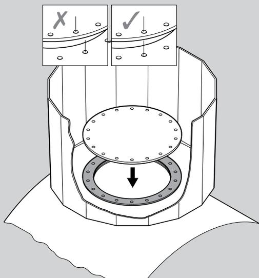
Coloque la tapa de la boca de hombre sobre la junta que acabamos de poner, asegurándose de que los agujeros quedan alineados unos con otros. Compruebe que la posición de la tapa es la correcta respecto a las conexiones para las tuberías y los taladros de la arqueta.
