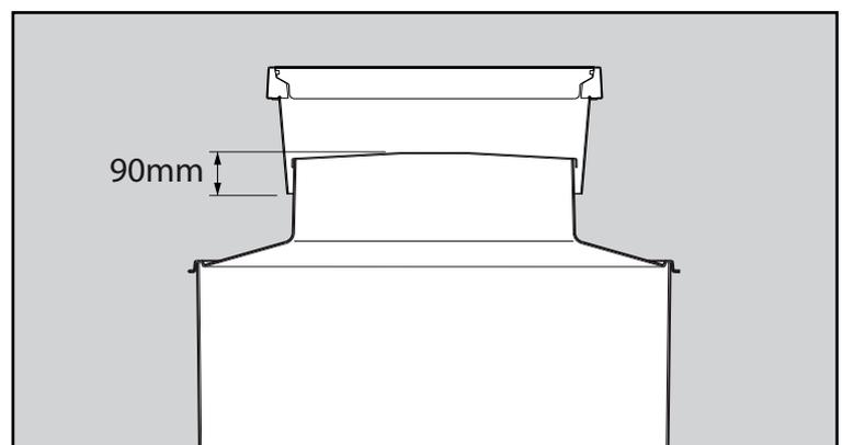
**Atención:** no corte la arqueta hasta que haya sido ensayada al vacío con las tuberías instaladas y terminadas.
