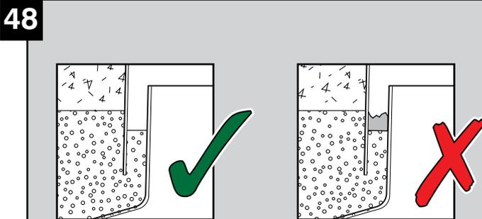
Compruebe que el espacio entre ambos está libre de hormigón y una profundidad mínima de 90 mm (120 mm con nivel freático alto)
