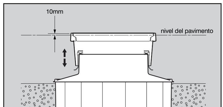
**45** Asegúrese de que el espacio entre el faldón y el realce quede libre de hormigón y exista un mínimo de 90 mm de solapamiento entre ambos (En caso de nivel freático alto 120 mm)
