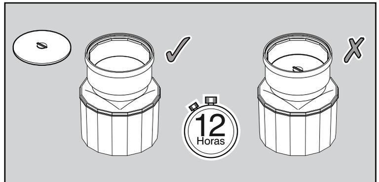
**58** **Ensayo de vacío opcional sobre el realce.**
