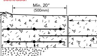
Expansion joint Junta de expansión filled with petrol rellena con masilla resistente a la gasolina.
